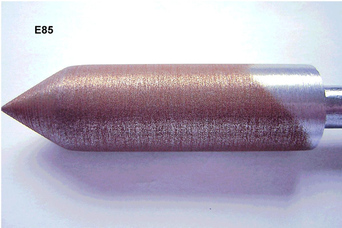
*Fig. 3 - Epreuve acier XC38 après 24 heures à 50°C avec le carburant SP98 (après brossage léger)*
